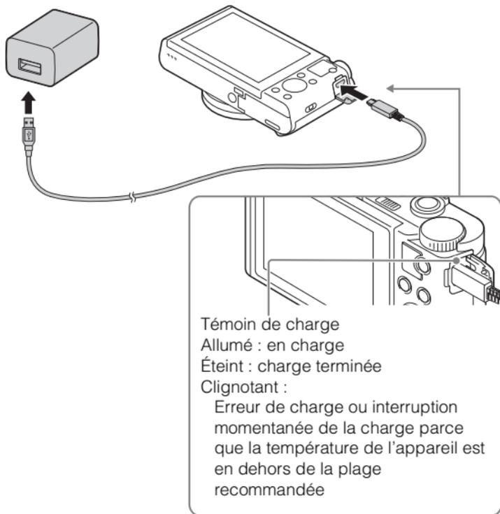
**1** Raccordez l'appareil à l'adaptateur secteur (fourni), en utilisant le câble micro-USB (fourni).
