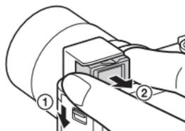
• Lorsque vous utilisez le viseur, faites glisser le commutateur de sortie du viseur vers le bas (①), puis faites sortir l'oculaire de visée du viseur jusqu'au clic (②).
